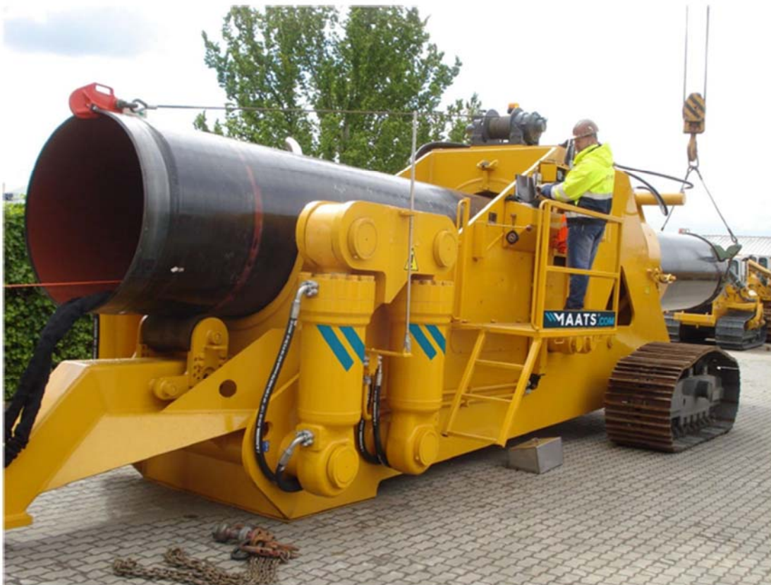
ФИГУРА 10. НАПРАВА НА СТУДЕНО ОГЪНАТИ КОЛЕНА С ТРЪБОГИБ (PIPE BENDING MACHINE)
